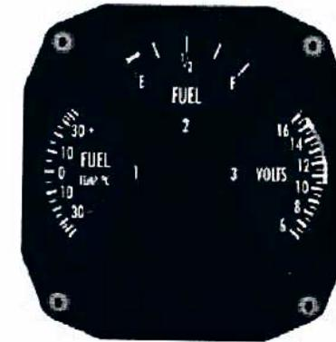
Figure 1-4 Exemple repère 10 (l'affichage du bas pourrait servir à l'OAT ou au réservoir optionnel).
