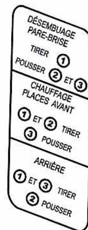
Figure 1-7 Etiquette commande de chauffage, parois droite dans la cabine.
