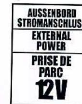
Figure 2-7 - Le cas échéant, sur la trappe d'accès à la prise de parc derrière l'aile sur la partie droite de l'avion
